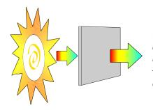
São utilizados para reduzir a intensidade de luz incidente, sem alterar a temperatura de cor do balanceamento. Eles são usados em conjunto com os filtros de conversão, quando trabalhamos em 3200°K e como filtros simples, quando o balanceamento é feito no interior.
